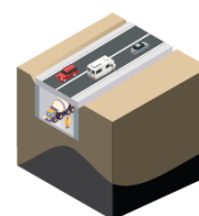
Radier réalisé en taupe sous la traverse
